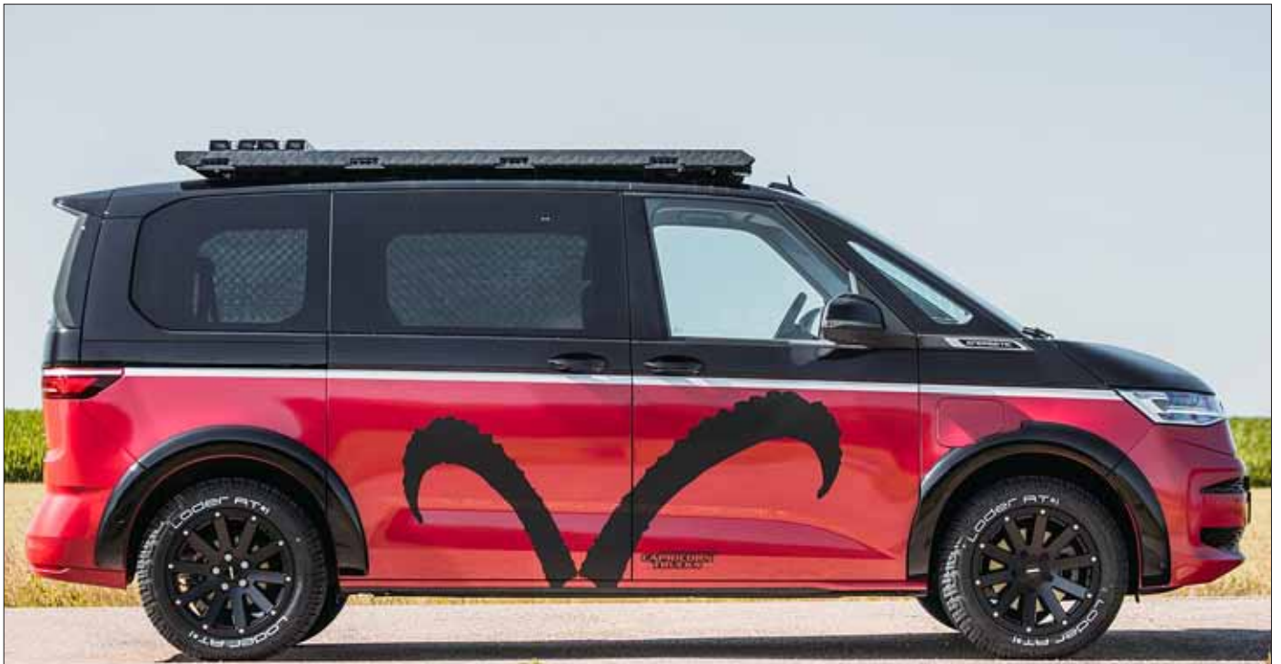
Felgen/Wheels Hanma black 18x9, Reifen Loder AT #1 255/55-18 Dachträger/Roof Rack, Höherlegung/Body Lift Kit 50 mm, Kotflügelverbreiterung/Fender Flares
