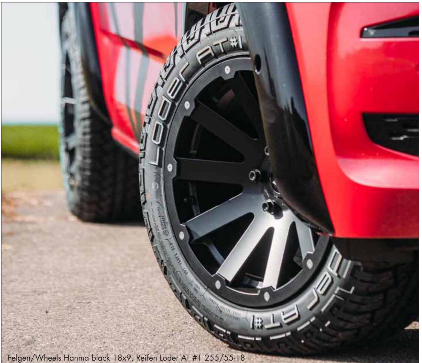
Felgen/Wheels Hanma black 18x9, Reifen Loder AT #1 255/55-18 Dachträger/Roof Rack, Höherlegung/Body Lift Kit 50 mm, Kotflügelverbreiterung/Fender Flares
